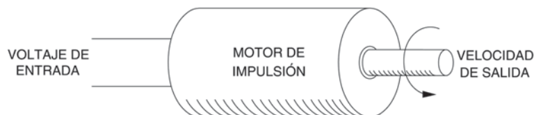
Figura 1-8. El Motor de impulsión es un convertidor voltaje-velocidad.
